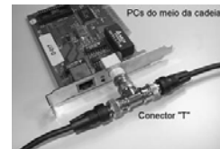
Conexão de cabos Thin Ethernet na placa de rede usando conector "T".
